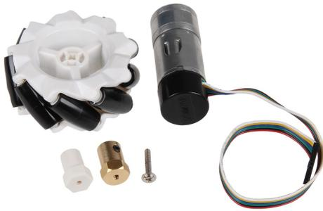
Das Omni-Wheel-Kit ist ein komplettes Set mit 4 hochwertigen Allseitenrädern mit passenden Motoren mit angebautem Encoder. Bei Omni-Wheels besteht die Lauffläche des Rades aus Rollen, deren Drehachsen im 45°-Winkel zur Drehachse des Rads liegen. Dies erlaubt ein Verschieben des Rades in seitlicher Drehrichtung. Ein Fahrzeug mit vier Omni-Wheels kann sich in praktisch jede Richtung bewegen ohne die Ausrichtung des Chassis ändern zu müssen.
